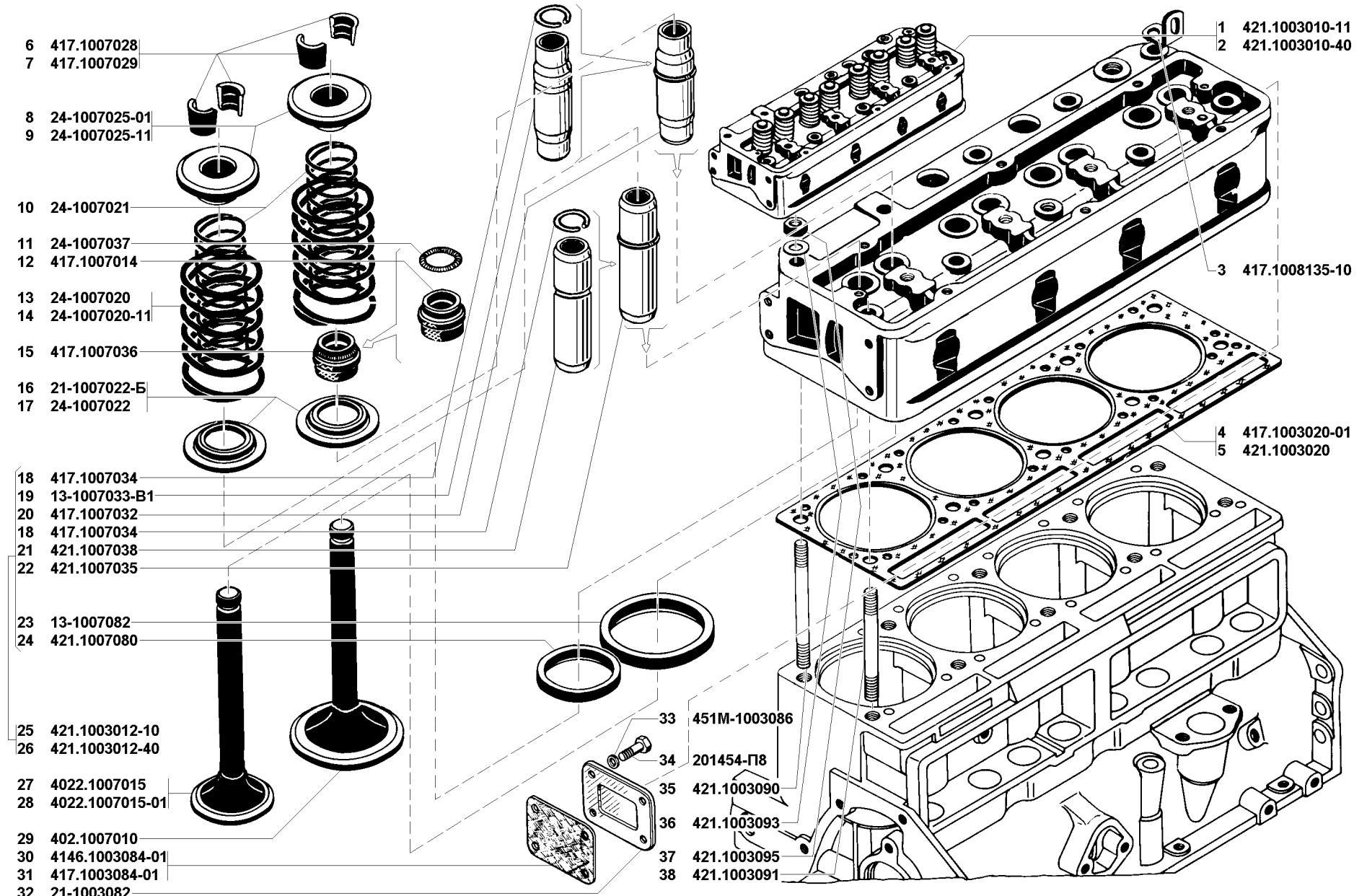
Рис. 4. Головка блока цилиндров с клапанами (1003)
